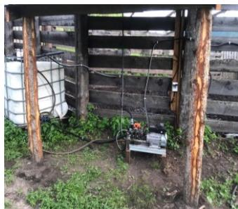
Рисунок 2 — Емкость для приготовления раствора, насос с электродвигателем
